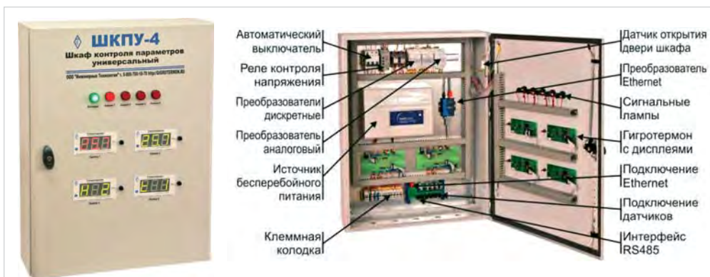
Рис. 2. Шкаф контроля параметров с 4 приборами «Гигротермон» и его комплектация
